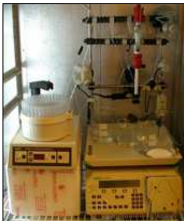
Rys. Kolumna z DEAE-celulozy podłączona do zestawu Bio-Rad.
